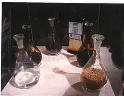
**Abbildung 4.** Zwischenstufen bei der Herstellung von bioliq®. Im Gegenuhrzeigersinn: Stroh, Pyrolyseöl, Pyrolysekoks, Biosynchrude, Kraftstoff.
