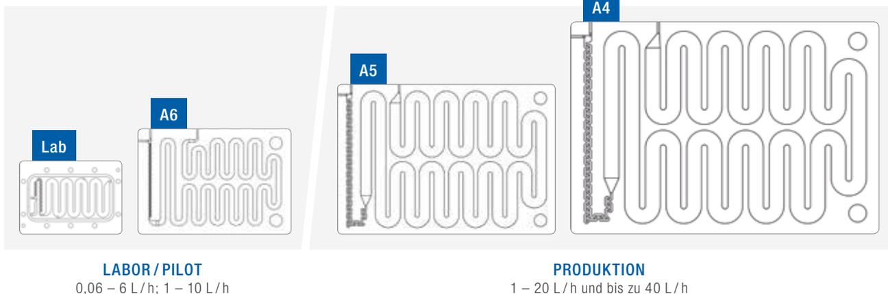
**FlowPlate® A6 und A5** – mit diesen Größen geht es beim Scale-up reibungslos weiter: Prozessentwicklung und Forschung sind damit ebenso realisierbar wie die Produktion unter cGMP-Bedingungen im Pilotmaßstab oder die Markteinführung eines Produkts. Das Kanaldesign ähnelt dem der Laborversion: Die hier geschlossenen Prozessplatten sind mit Kanalstrukturen für Misch- und Verweilvolumen ausgestattet, die je nach Anforderungen leicht austauschbar sind.
