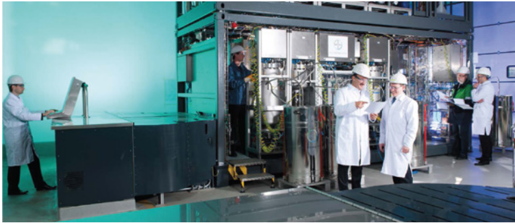
Abbildung 3: Modulare Prozesseinheit in Containerbauweise im Technikum INVITE 27
